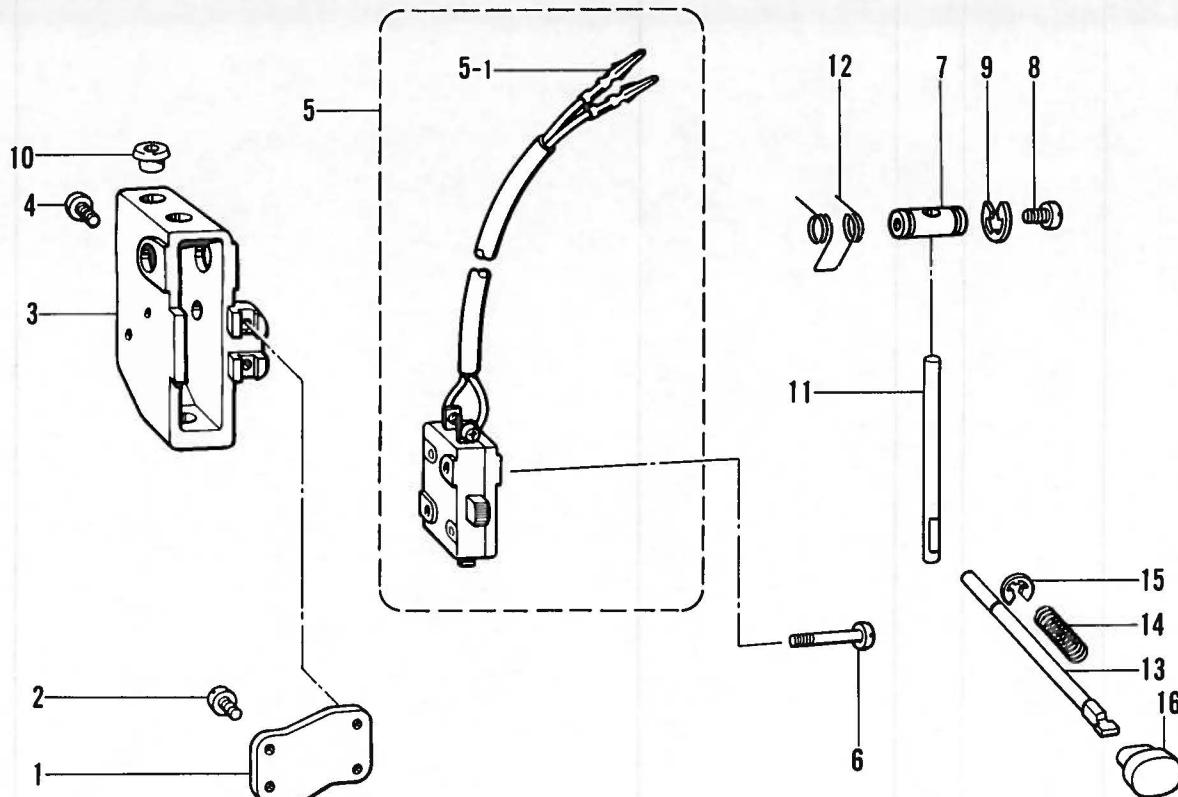
P. 糸ユルメ関係 / Tension release mechanism / Spannungsverminderungsvorrichtung /
