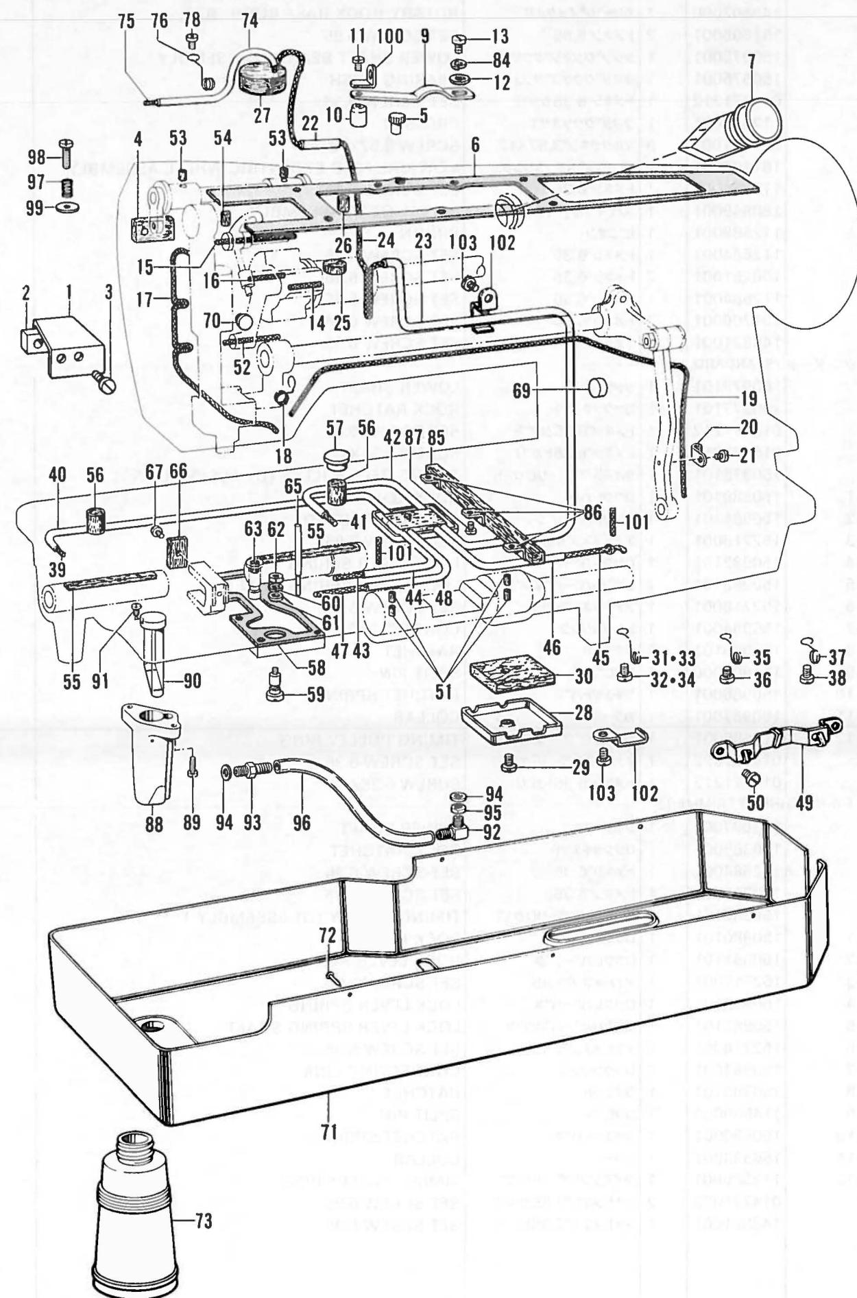
L. 給油潤滑関係/Lubrication/Schmierung/
