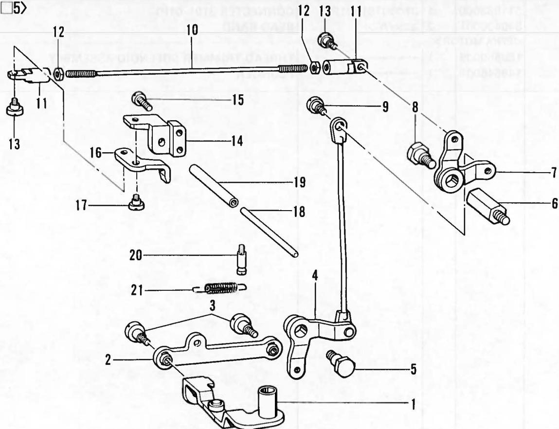
Q. 逆転スイッチ関係 / Quick reverse switch mechanism / Umkehrschalter /
