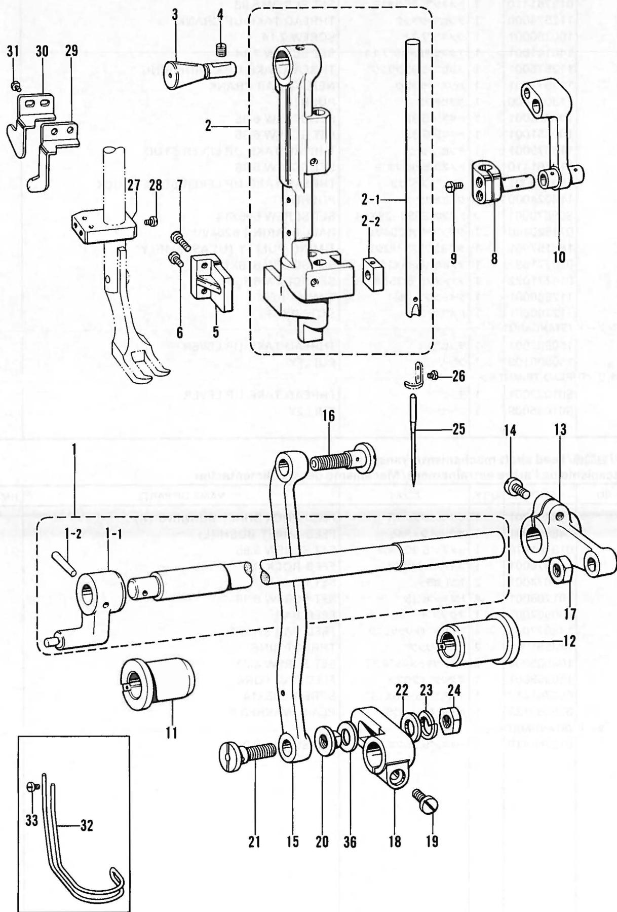
D. 針棒揺動関係 /Needle bar rocking mechanism/Nadelstangenbetätigung/
