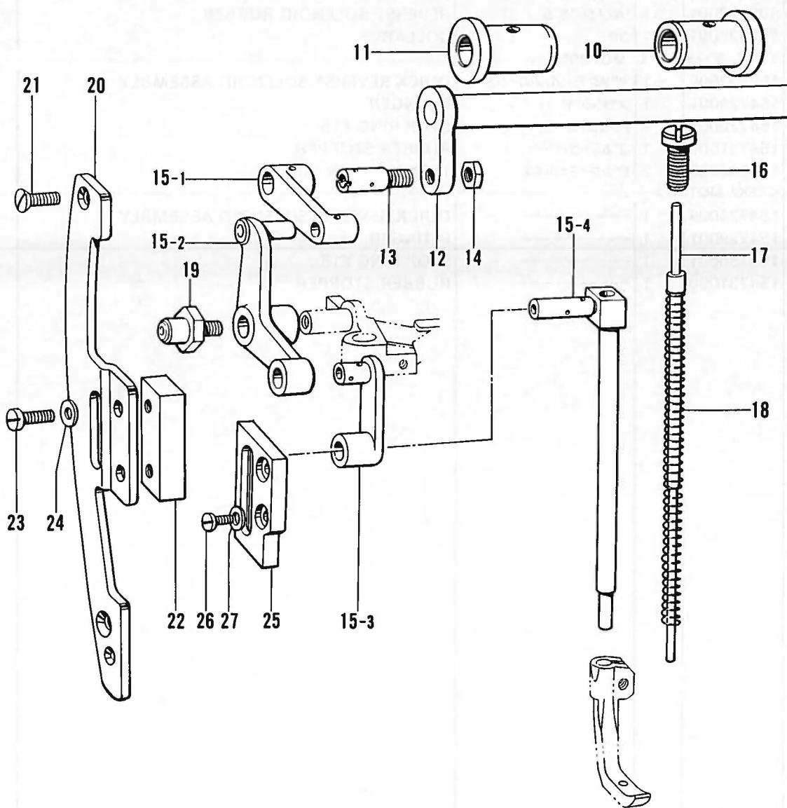
H. 上送リ関係 / Upper feed mechanism / Ober fadenabschneider /
